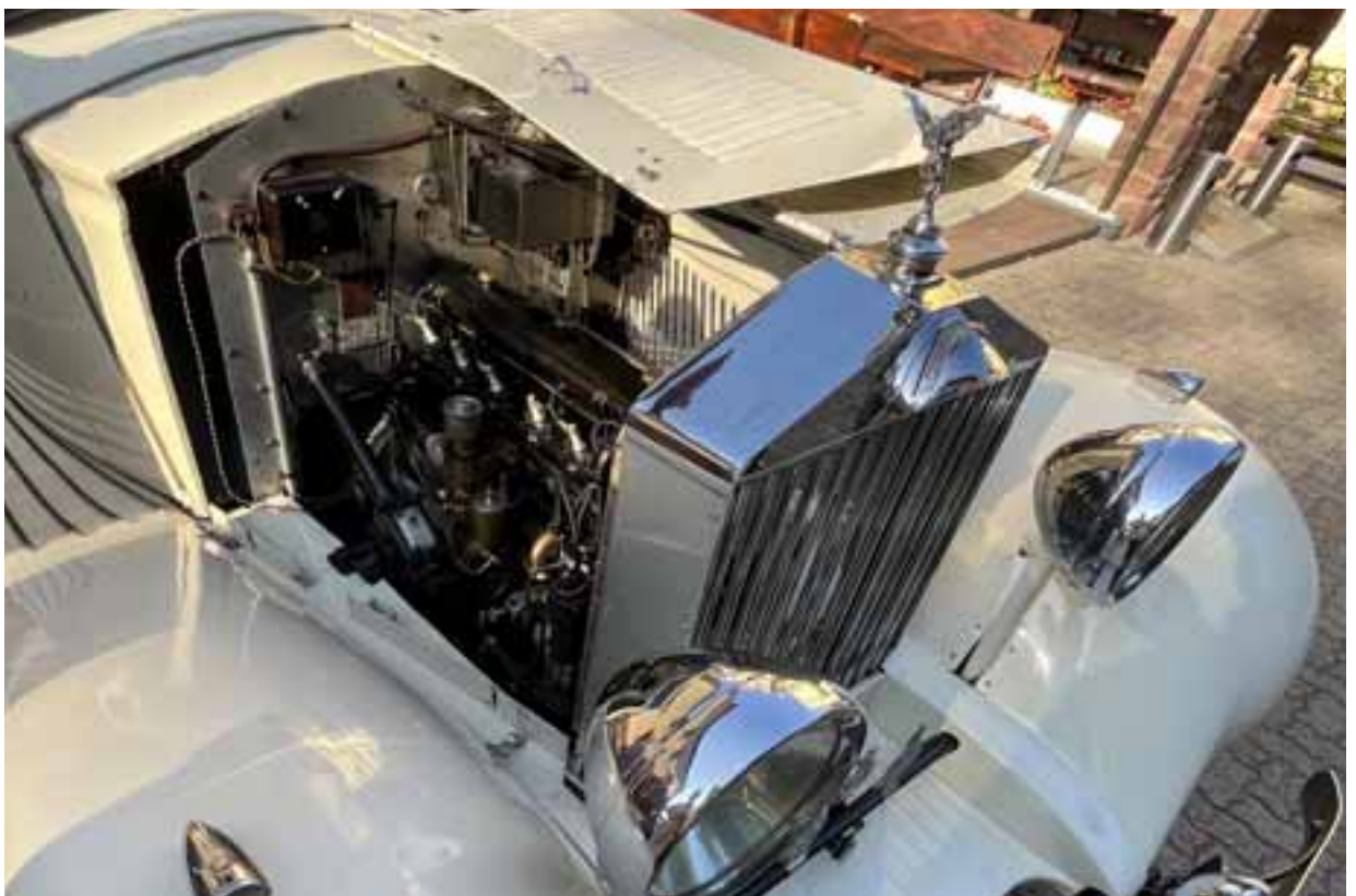
An der Spritzwand gut zu sehen, dieser Twenty trug vorher eine andere, schmalere Karosserie.
